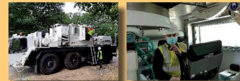
Le véhicule EBPP est un poste de pilotage des engins de travaux publics téléopérés EPPELL (pelleteuse) et EBULL (Bulldozer). Sa cabine blindée (52T) et son système spécifique de ventilation permettent de réaliser des missions de reconnaissance visuelle en milieu nucléaire.
